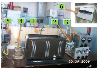
Зураг 1б. Уураас суулгах химийн CVD реакторын харагдах байдал: 1-халаагч утсаар ороогдсон хэвтээ болор хоолой, 2-аргон, устөрөгч, пропан-бутан хийнүүдийн урсгалыг тохируулж холин болор хоолойд оруулах хэсэг, 3- болор хоолойг халаах цахилгаан тэжээл, 4-хоолойгоос гарах халуун хийг тэсрэх аюулгүй зайлуулах хэсэг, 5-болор хоолой доторх орчны температурыг хянах термoxосын дижитал термометр, 6-болор хоолойноос гарган авсан урвалын бүтээгдэхүүн бүхий шаазан завь.
