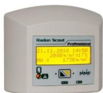
Зураг 1. Герман улсад үйлдвэрлэсэн Radon Scout Professional (SARAD) төхөөрөмж.
