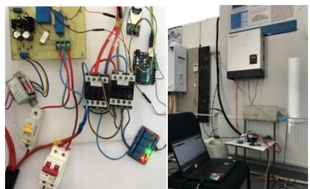
Зураг 7. Удирдлагын төхөөрөмж нарны зайн системтэй холбогдсон байдал
