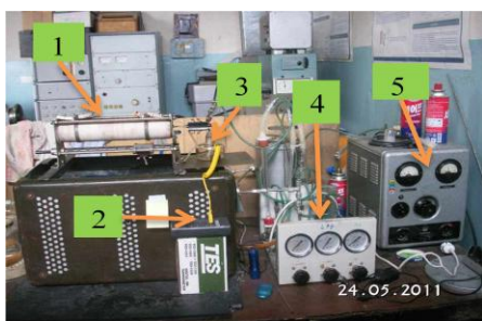
Зураг 4. Бичил зуух: 1- Зуухны их бие, 2- Зуухны температурыг хэмжигч дижитал термометр, 3- Аргон хийг халаагч дэн, 4-Аргон хийн урсгалыг хянах блок, 5- Зуухны цахилгаан тэжээл.
