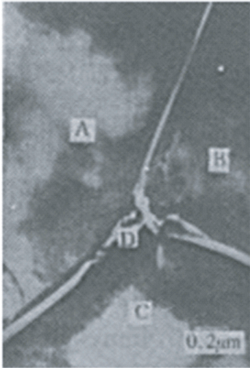
Зураг 1: NdFeB соронзны микрбүтэц: A, B, C нь Nd 2 Fe 14 B, D нь Nd –ээр баялаг фаз, нарийн гэрэлтэй мүүж[1]
