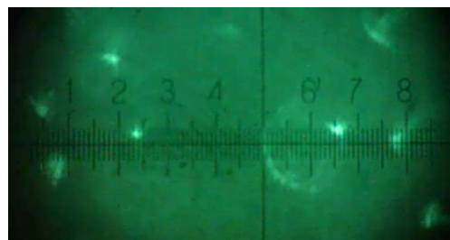
Зураг 5. Микроскопын окулярын хавтгайд үүсэж буй бөөмцөрийн дүрс (Өсгөлт 400х, окулярын хуваарийн үнэ d=2.25 мкм).
