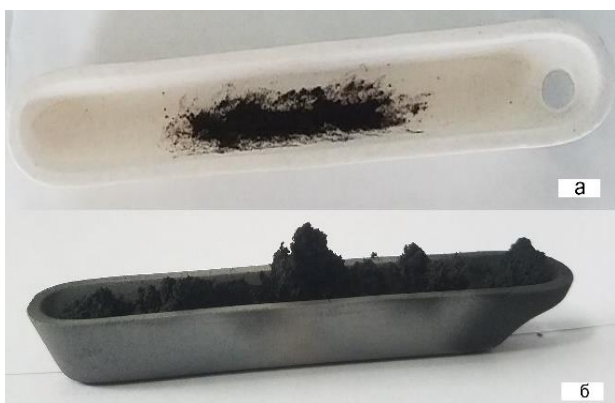
Зураг 6. (а) Шаазан тигельд Fe-Co/Al 2 O 3 катализаторыг хийсэн байдал. (б) Урвалын бүтээгдэхүүн. Туршилтаар 0.5 г орчим НТНХ гарган авсан.
