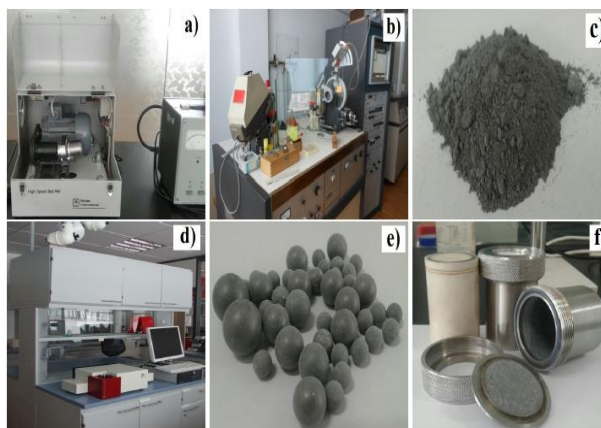
1-р зураг. Нунтаглах процесс явуулахад ашигласан багажууд: a) Өндөр энергийн чичиргээт бөмбөгөн тээрэм, b) рентген дифрактометр, c) нунтаг \text{TiO}_2 дээж, d) Фотоны хөндлөн корреляцийн спектроскоп (PCCS with Nanorho), e) янз бүрийн диаметртэй зэвэрдэггүй ган бөмбөгүүд, f) нунтаг дээж хийх зориулалттай ган сав.
