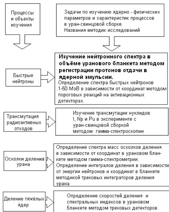
Рис.1. Программа эксперимента по облучению свинцовой мишени с четырёхсекционным урановым бланкетом на протонном пучке сверхпроводящего ускорителя-нуклотрона Лаборатории Высоких Энергий ОИЯИ при энергии 1.5 ГэВ.
