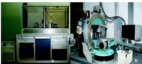
Зураг. 2 а) STOE STADI 4 монокристаллын дифрактометр, б) дөрвөн эргэлтийн тэнхлэгтэй гониометр.
