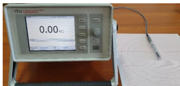
3-р зураг. PTW Unidos 10002 электромтр ба PTW30004 иончлолын камер
