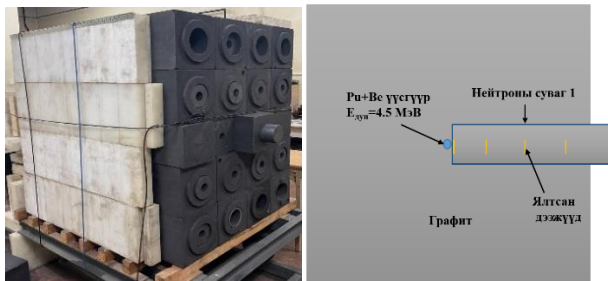
Зураг 1. Графитан удаашруулагчтай нейтроны Pu-Be үүсгүүр, дээж шаргах схем
