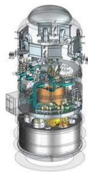
Зураг 2. RITM 200N цөмийн эрчим хүчний реактор.
