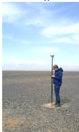
Зураг 4. Хос долгионт байршил тогтоогч багажийг ашиглаж буй байдал
