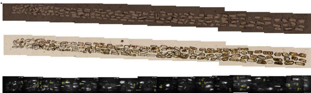
Зураг 11. Дээж 4680. Цирконы мөхлөгүүдэд хэмжилт хийсэн байдал
