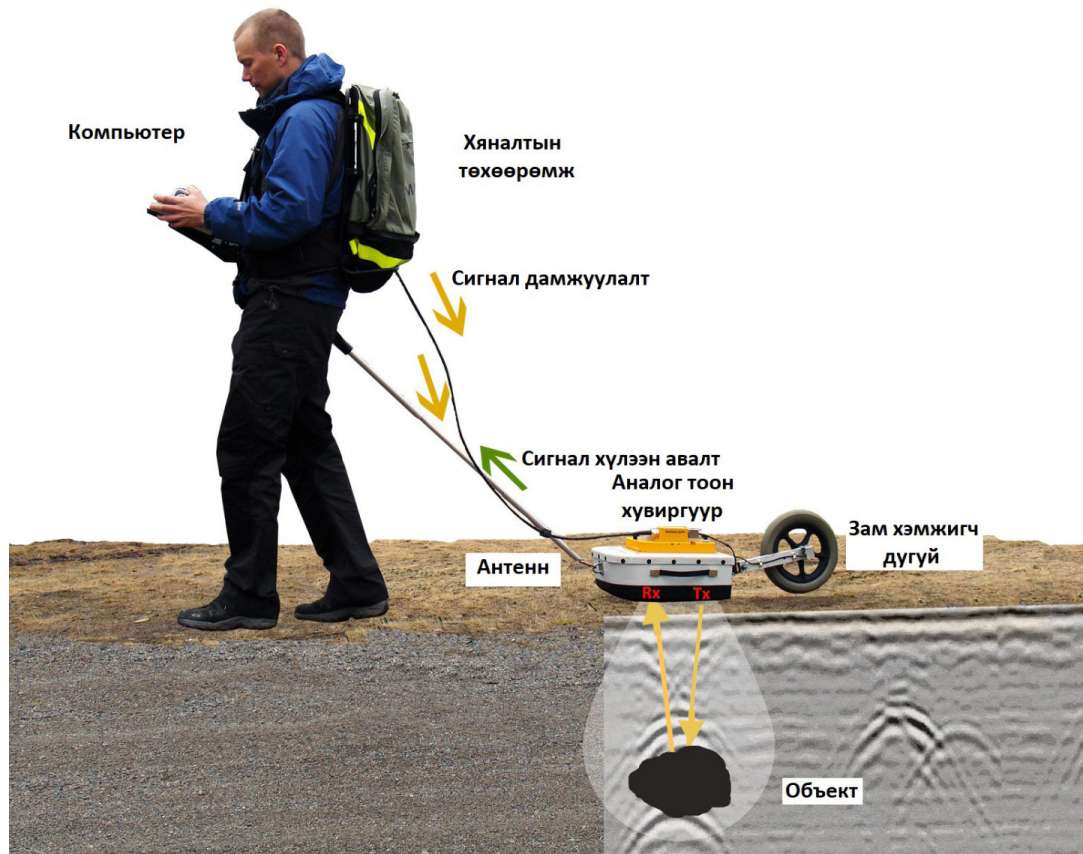
Зураг 1. Георадарын Common Offset (CO) аргачлалын хамгаалагдсан антений хэмжилт, ажиллах зарчим. Хэмжилтийн алхам хэмжигч дугуйгаар замаа хэмжинэ, антенд өгөх импульс болон хэмжилтийн мэдээллийг оптик кабелиар хяналтын төхөөрөмж рүү дамжуулж түүнээс цааш нь хэмжилтийн компьютерт мэдээллээ дамжуулж хадгалах замаар георадарын хэмжилт хийгдэнэ.
