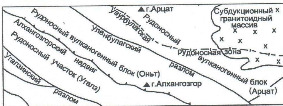
Рис.2. Схема размещения золото-медноколчеданных рудоносных блоков
