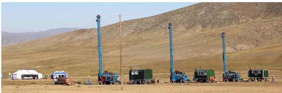
Зураг 3. Геологи-хайгуулын цохилтот өрөмдлөгийн төхөөрөмжүүд, явагдах ерөнхий байдал (Монгол улсын Төв аймгийн Заамарын алтны шороон ордын жишээ дээр, 2017 он)
