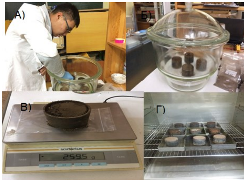
Зураг 4. А) ба Б) Хөрсний чийгийн үзүүлэлт; В) Хөрсийг жигнэх; Г) Хөрсийг хатаах
