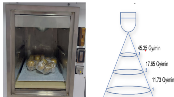
Зураг 1: а) Рентген шарах төхөөрөмжснд төмсийг шарж буй байдал б) Рентгений эхүүсвэрээс харгалзах зайг хамааруулан тунгийн чадлыг тооцоолсон нь
