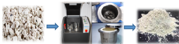
Зураг 2: Байгалийн цеолитыг бөмбөлөгт тээрмээр нунтаглаж угаасны дараа
